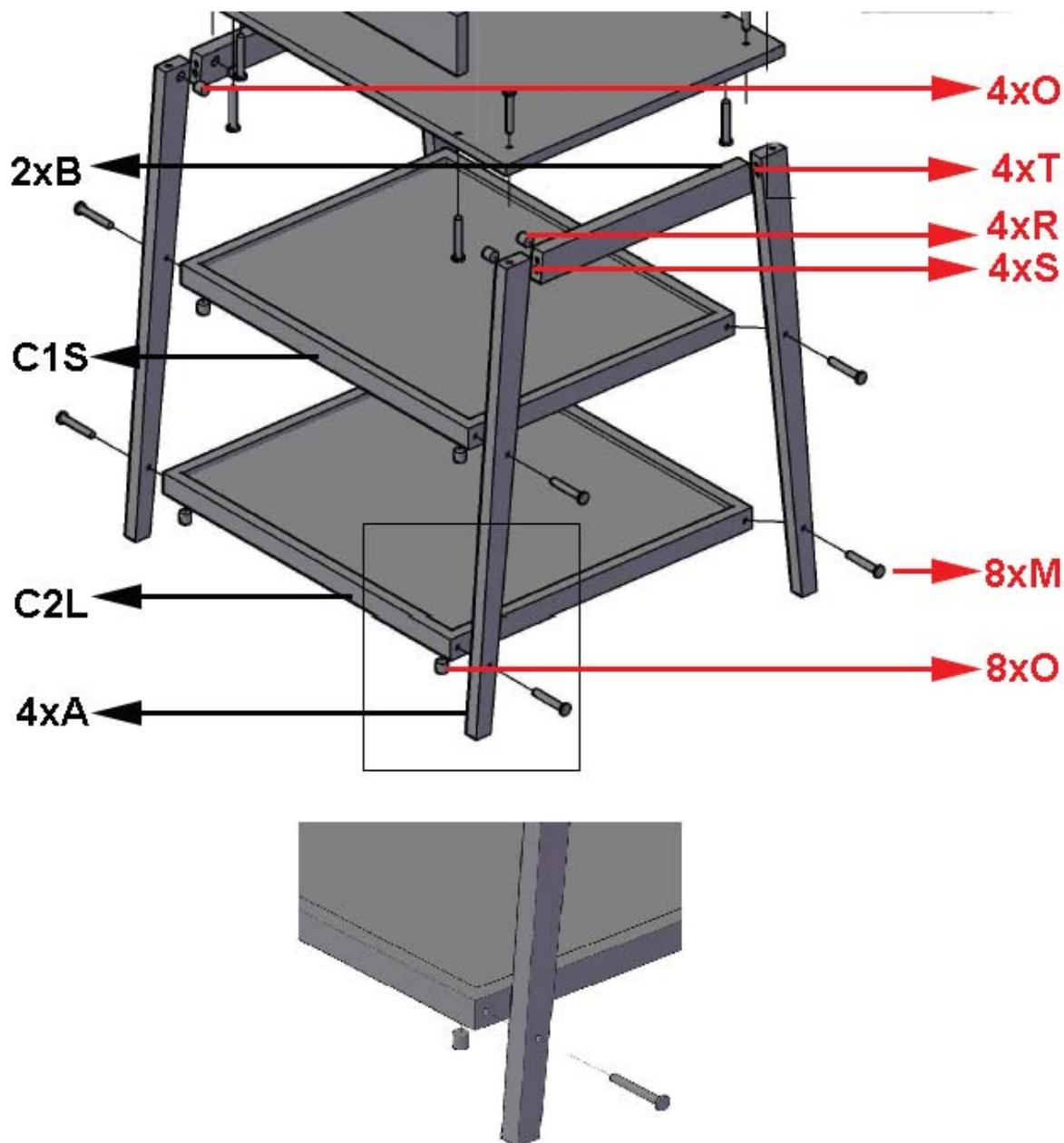
**Schritt 1 :** Verwenden Sie beide Querstangen **B**, vier Holzdübel **T**, die vier Füße **A**, die Regale **C1S** und **C2L**, vier Exzenter **R**, vier Verbindungsbolzen **S**, zwölf Zylindermuttern **O** und acht Bolzen **M**
