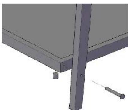
**Etape 1:** Utilisez les deux traverses **B**, quatre chevilles en bois **T**, les quatre pieds **A**, les étagères **C1S** et **C2L**, quatre excentriques **R**, quatre boulons de raccord **S**, douze écrous cylindriques **O** et huit boulons **M**
