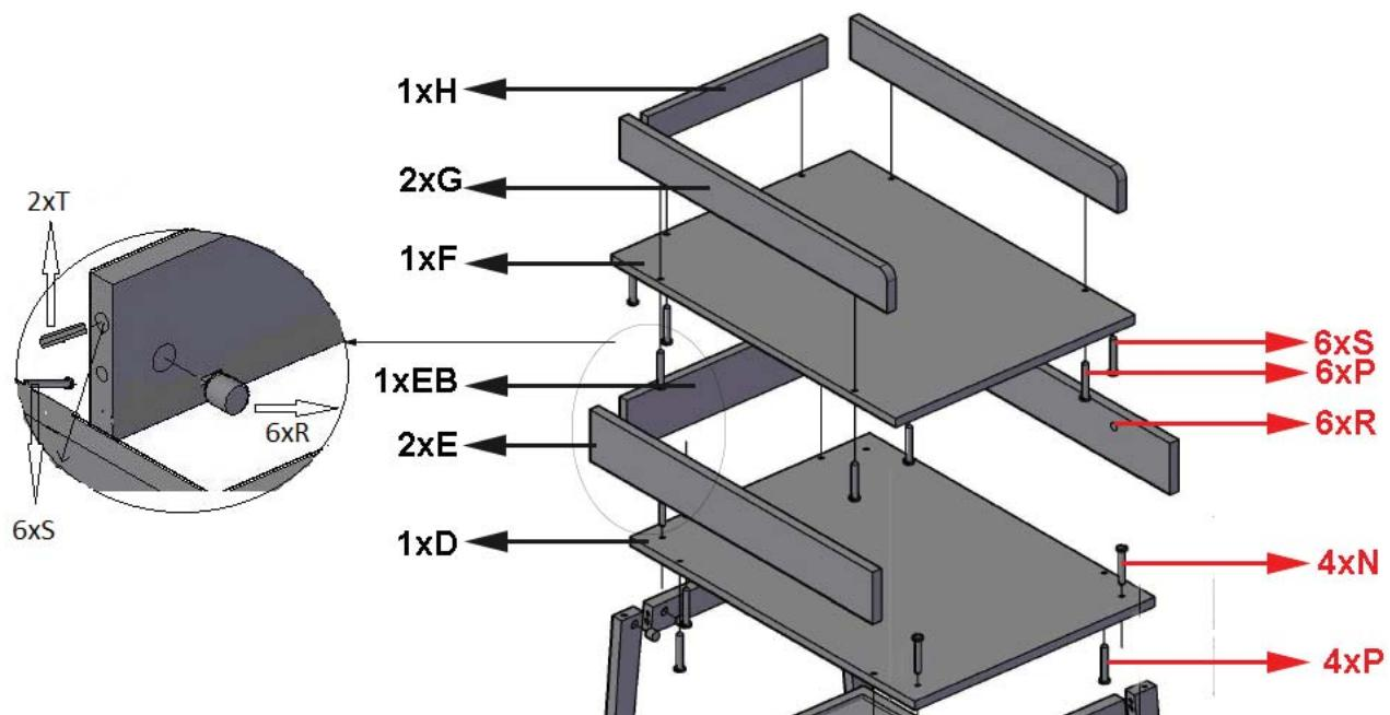
**Schritt 2 :** Verwenden Sie den Rahmen von Schritt 1, die Obenplatte **D**, vier Bolzen **N**, die Rückseite **EB**, beide Seiten **E**, zehn Holzschrauben **P**, zwei Holzdübel **T**, das Deckblatt **F**, sechs Verbindungsbolzen **S**, sechs Exzenter **R**, die Rückseite **H** und beide Stützprofile **G**
