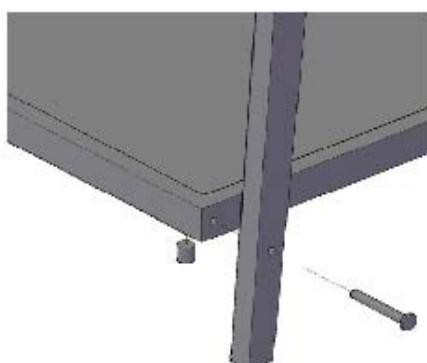
**Stap 1 :** Gebruik beide dwarsbalken **B**, vier houten drevels **T**, de vier poten **A**, de legplanken **C1S** en **C2L**, vier excentrieken **R**, vier verbindingsbouten **S**, twaalf cilindrische moeren **O** en acht bouten **M**
