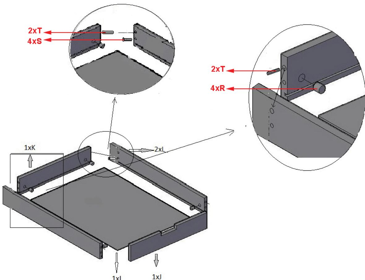
**Schritt 3 :** Verwenden Sie das zusammengebauten Möbel, das Schubladenfront **J**, den Rücken **K**, beide Schubladenseiten **L**, den Boden **I**, vier Holzdübel **T**, vier Verbindungsbolzen **S** und vier Exzenter **R**
