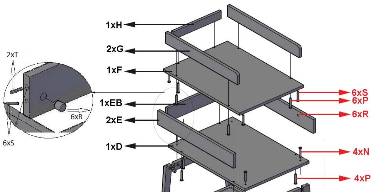
**Stap 2 :** Gebruik het frame van stap 1, het bovenblad **D**, vier bouten **N**, de rug **EB**, beide zijkanten **E**, tien houtschroeven **P**, twee houten drevels **T**, het afdekblad **F**, zes verbindingsbouten **S**, zes excentrieken **R**, de rug **H** en beide steunprofielen **G**
